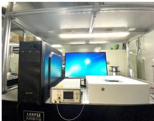
**TranCT-215** 可用于光链路传输损耗测量，具有超高的损耗测试动态范围和灵敏度，超高的空间分辨率和损耗定位精度。该系统可选配光纤传感功能软件，从而使该系统实现多通道同时采集、分布式光纤应变及温度测量功能。
